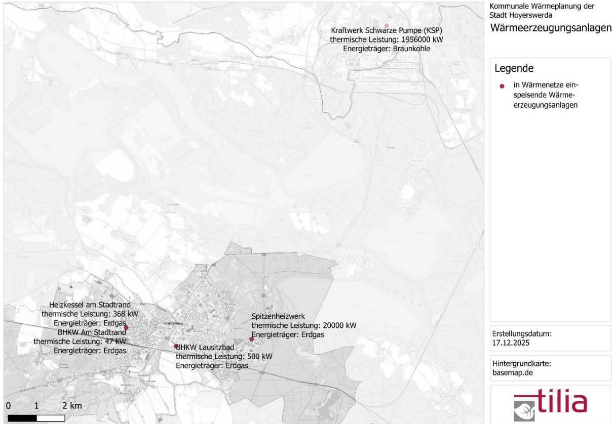
Abbildung 5: Wärmeerzeugungsanlagen, die in Wärmenetze einspeisen
